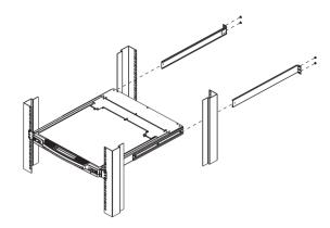
3. После того как Г-образные кронштейны закреплены, полностью закрутите винты передних кронштейнов.
