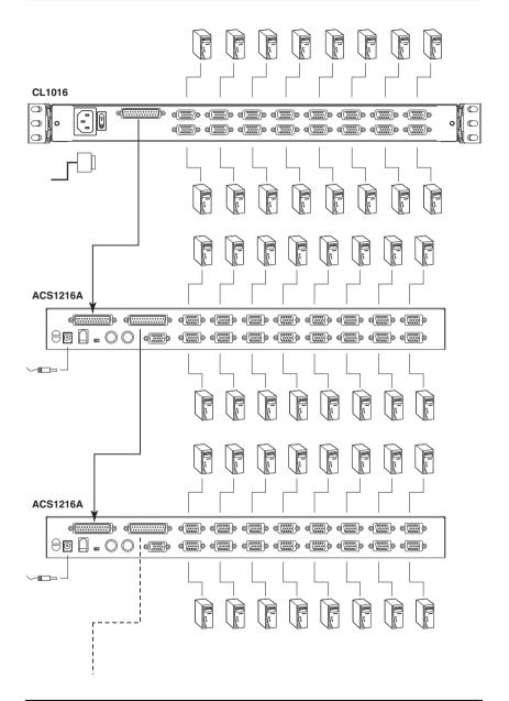
**Примечание.** Выше изображена модель CL1016. Задняя панель CL1008 идентична задней панели CL1016, только вместо 8 KVM-портов используется 16.
