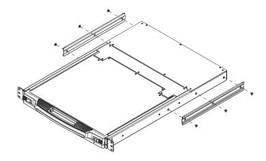
2. Установите внутри стойки левую и правую монтажные направляющие из комплекта для *упрощенного монтажа*. Фланец, поддерживающий переключатель, будет направлен внутрь.
