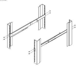
3. Установите переключатель на опорные фланцы. Используя идущие в комплекте винты свободно прикрутите переднюю часть переключателя к передней части стойки (закрутите винты наполовину).
