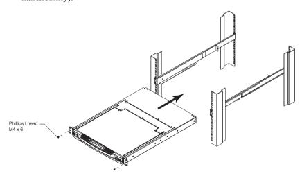
4. Задвигайте салазки заднего крепления по направляющим планкам, пока они не коснутся задней части переключателя, а затем, используя идущие в комплекте винты, прикрутите планки к задней части переключателя (закрутите винты полностью).
