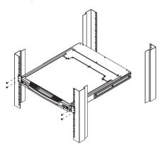
2. Пока первый человек продолжает удерживать переключатель в выбранном положении, второй человек задвигает Г-образные кронштейны в боковые монтажные кронштейны переключателя сзади до тех пор, пока фланцы кронштейнов не коснутся стойки, после чего прикручивает Г-образные кронштейны к стойке.
